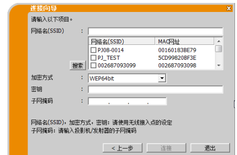
圖 3.2.3.6: 投影機/發射器通過無線 LAN 與接入點連接
